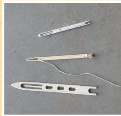
Aiguille à ramender : Permet de réparer les filets de pêche.
